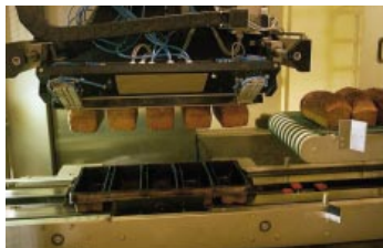
Per uur worden 4500 broden uit de bakblikken gehaald.
